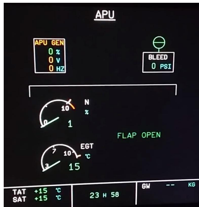
Slika 6. Poruka koja pokazuje da je otvoren poklopac uvodnika
