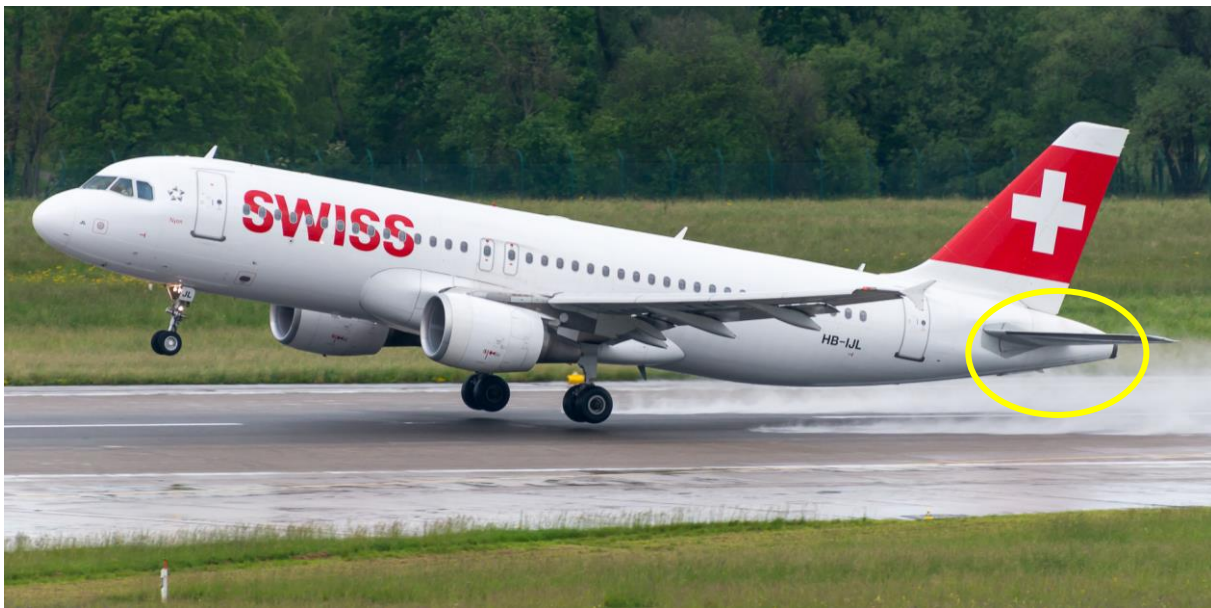
Slika 1. Smještaj APU-a na zrakoplovu Airbus A320 Izvor: https://www.jetphotos.com/photo/8293452 , 25.7.2018.
