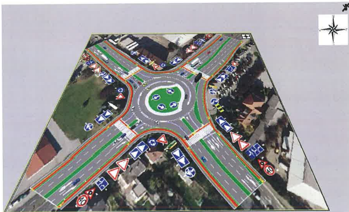
Slika 68. Simulacijski model varijante 3 – turbo kružno raskrižje
