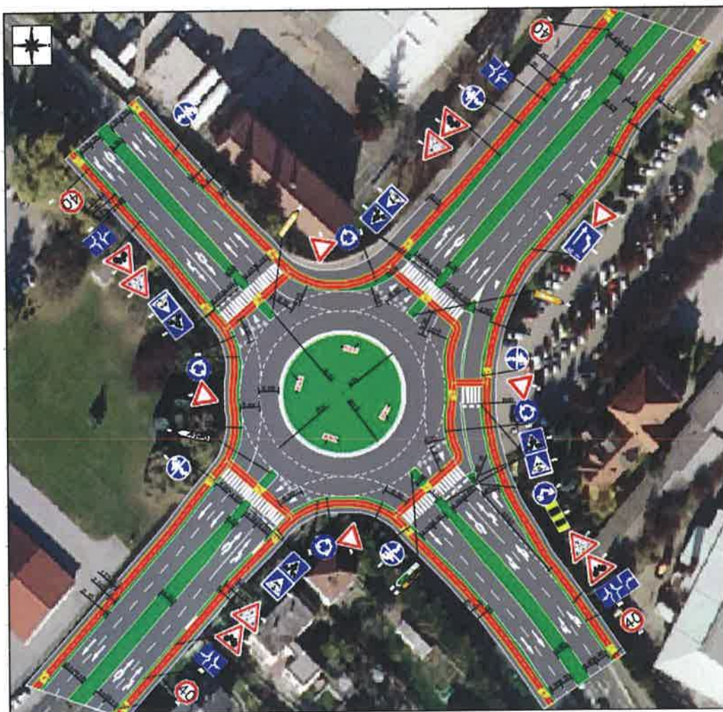
Slika 50. Varijanta 2 – dvotračno raskrižje s kružnim tokom prometa
