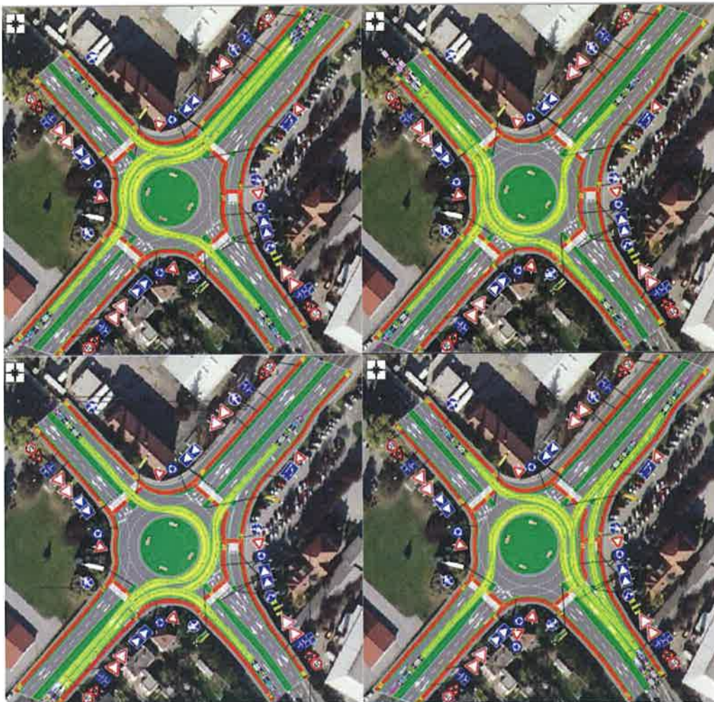
Slika 51. Provjera trajektorija mjerodavnog vozila
