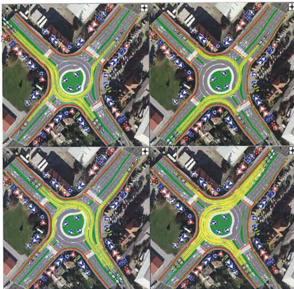
Slika 58. Provjera trajektorija mjerodavnog vozila
