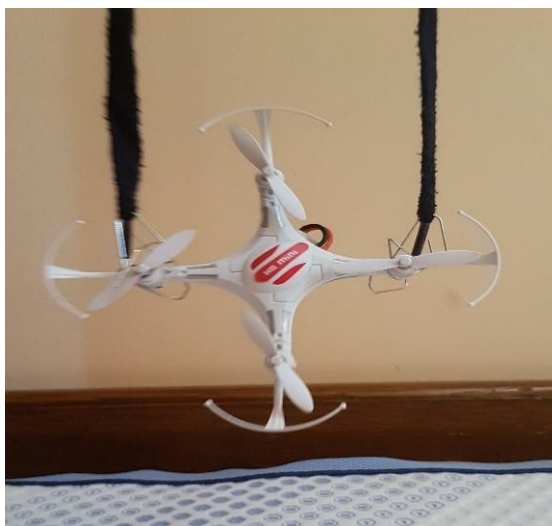
Slika 14 - Postavka za određivanje momenata oko x osi
