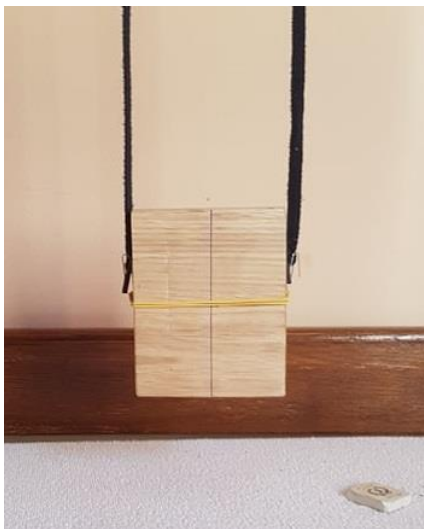
Slika 10 - Postavka za određivanje momenata oko x osi
