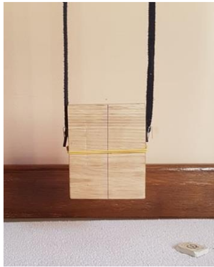
Slika 10 - Postavka za određivanje momenata oko x osi
