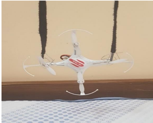
Slika 16 - Postavka za određivanje momenata oko y osi
