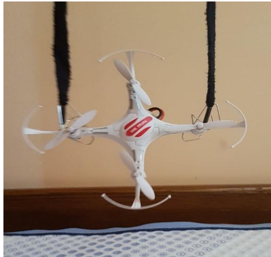
Slika 14 - Postavka za određivanje momenata oko x osi
