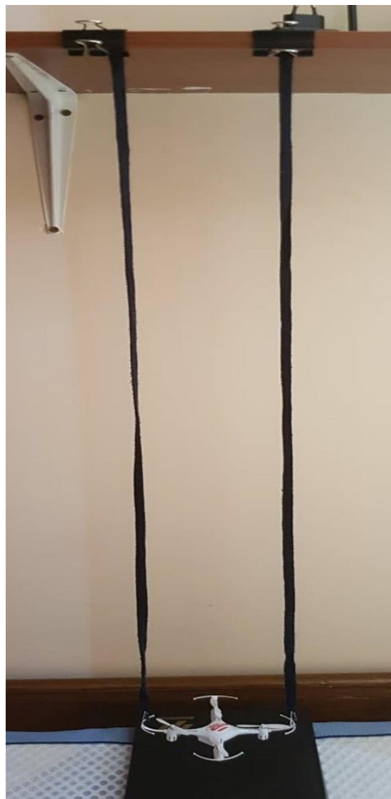
Slika 17 - Cjelokupna postavka za računanje momenata oko osi z
