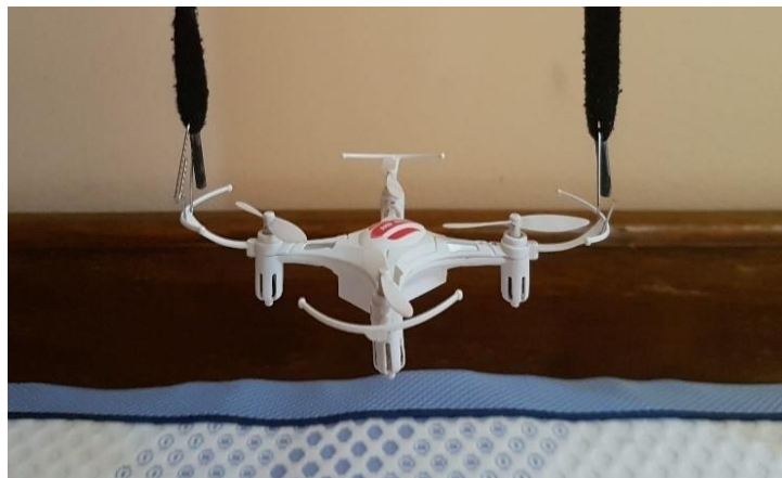
Slika 15 - Postavka za određivanje momenata oko z osi
