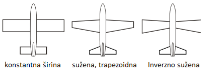
Slika 5 - Neki od tipova izrade krila
