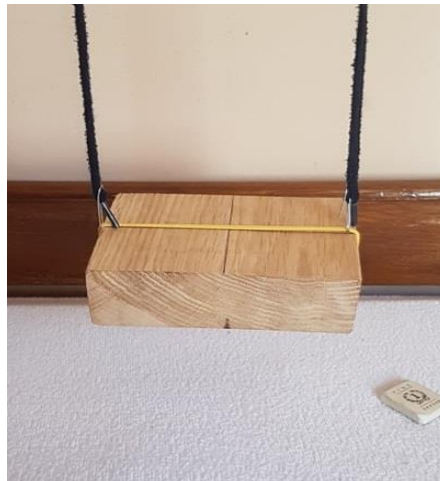
Slika 11 - Postavka za određivanje momenata oko y osi
