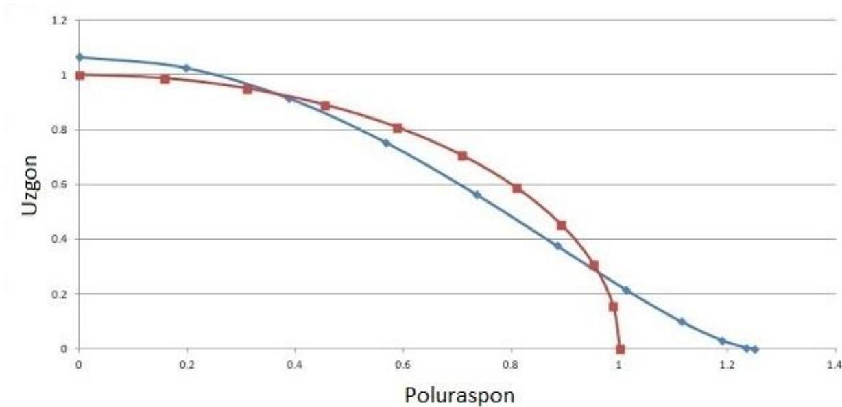
Slika 13 Zvonolika i eliptična raspodjela po polurasponu
