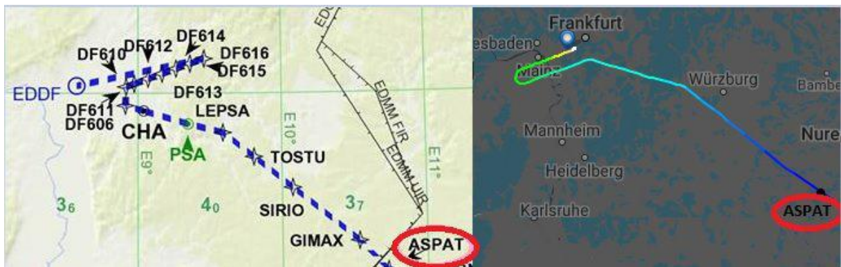
Slika 19. Usporedba prilaza na aerodrom EDDF [9]
