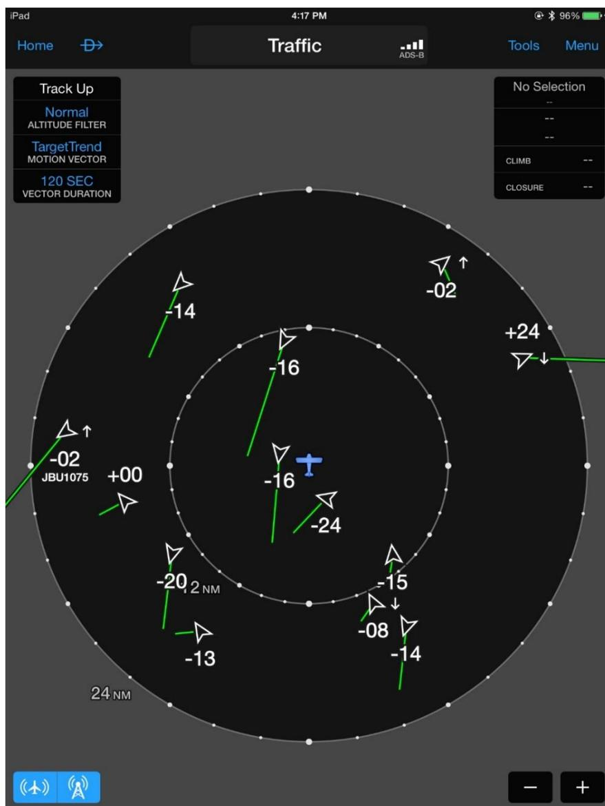
Slika 2. Mobilna aplikacija Garmin;-prikaz prometa korištenjem ADS sustava, [11]
