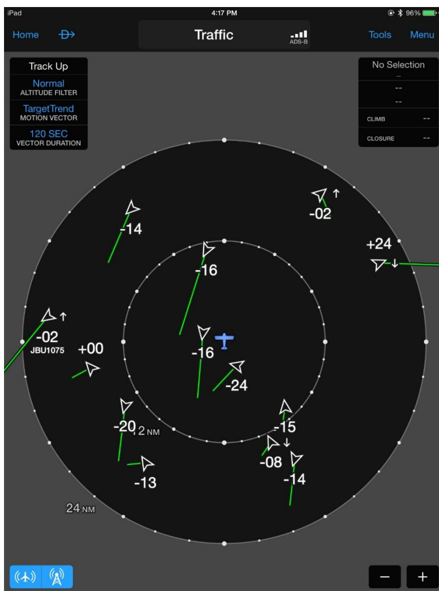
Slika 2. Mobilna aplikacija Garmin;-prikaz prometa korištenjem ADS sustava, [11]
