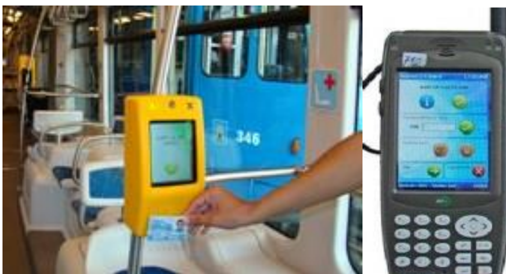
Slika 10: Uređaj za registriranje karata i ručni uređaj za kontrolu karata
