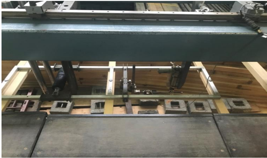
Slika 29: Prikaz modela za mjerenje sile dinamometrom
