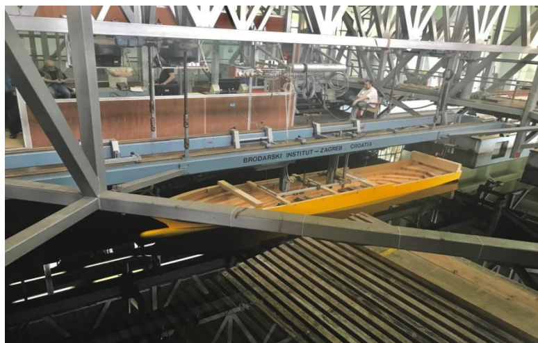
Slika 28: Model za ispitivanje otpora broda
