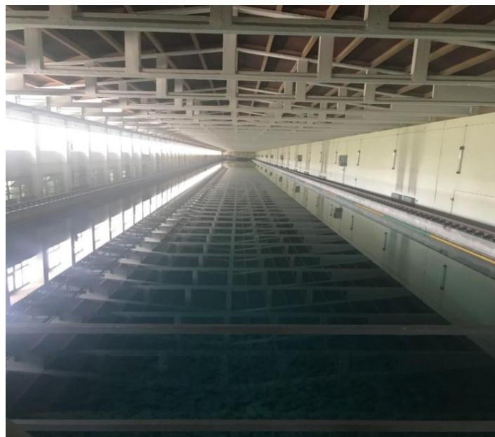
Slika 26: Bazen za ispitivanje sila otpora broda
