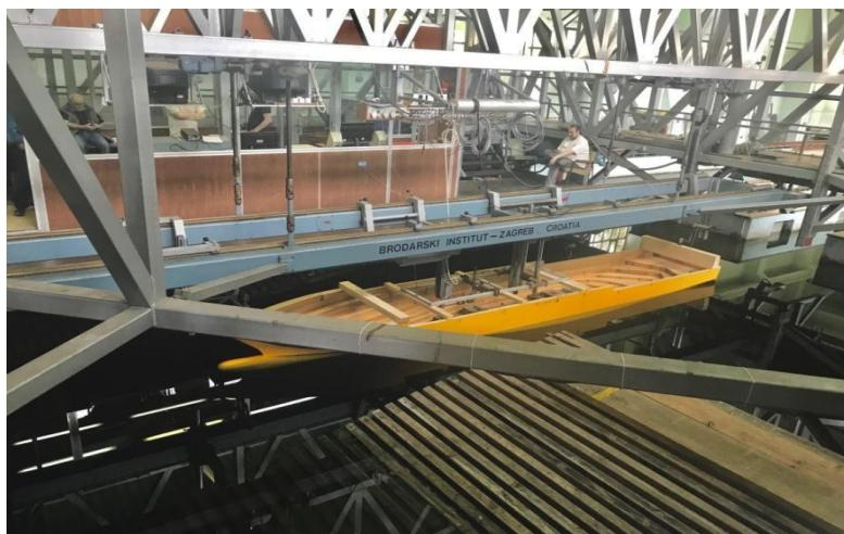
**Slika 28: Model za ispitivanje otpora broda**
