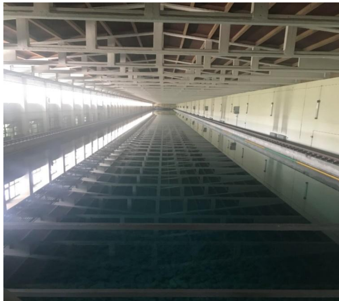
Slika 26: Bazen za ispitivanje sila otpora broda Izvor: Brodarski institut u Zagrebu
