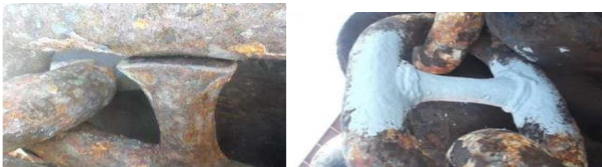
Slika 25. Prikaz nepravilnog zavarivanja
