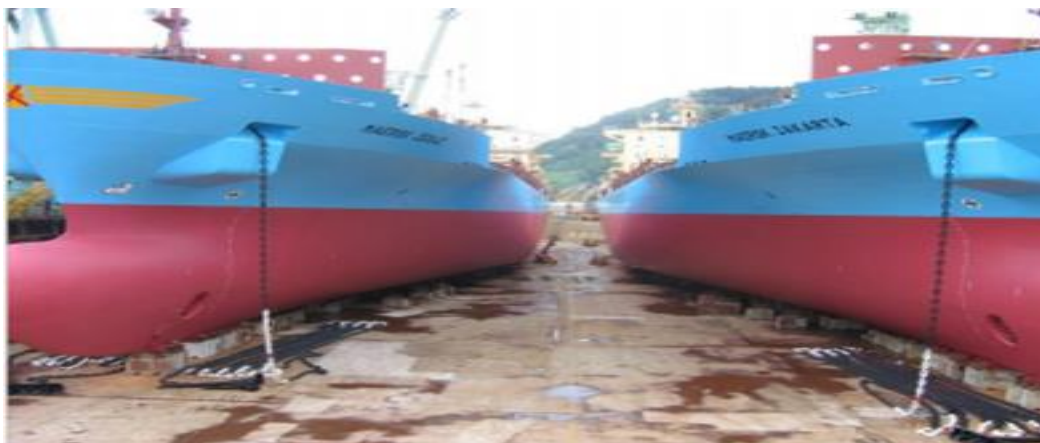
Slika 19. Razvlačenje sidrenog lanca i polaganje sidra na dok broda
