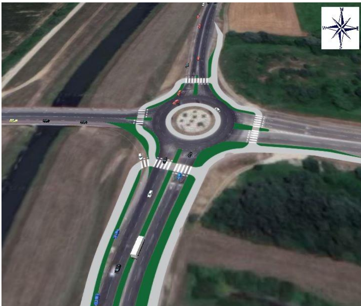
Slika 36. Prikaz simulacije idejnog prometnog rješenja „Raskrižja broj 1“
