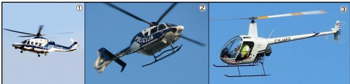
Slika 17: Zrakoplovi u posjedu MUP-a (1. Augusta Westland AW 139, 2. Airbus H135, 3. Robinson R22 Beta)
