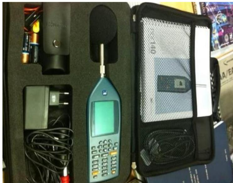
Slika 12. Nor140 mjerna oprema, [14]
