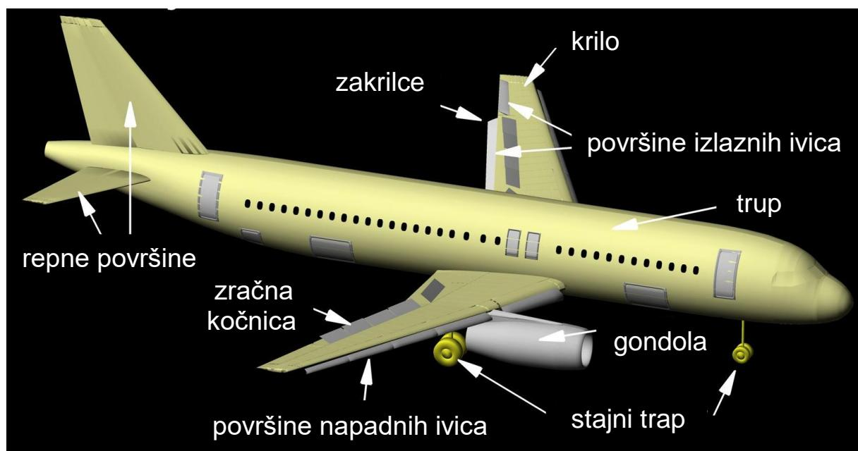
Slika 4. Općeniti prikaz izvora aerodinamičke buke, [6]
