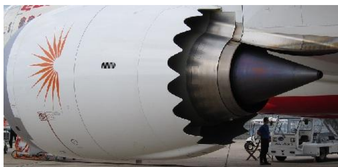
Slika 28. Prikaz promjene mlaznice u svrhu smanjenja buke izazvane pogonskim sustavom. (smanjenje buke do max 5 dB, ali i poremećaj same aerodinamike te potrošnje goriva i smanjenje potiska ) [ Izvor : https://commons.wikimedia.org ]
