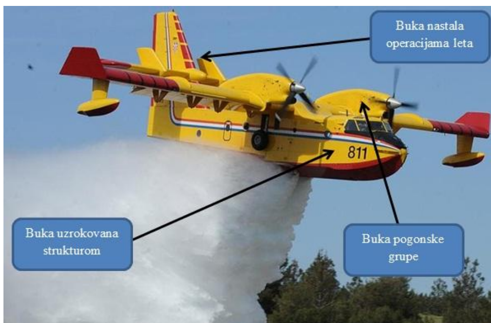
Slika 6. Izvori buke na zrakoplovu [ Izvor: www.airliners.net ]
