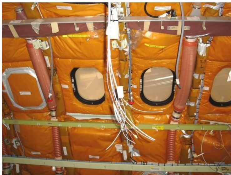
Slika 29. Primjer oblaganja kabine zrakoplova u svrhu smanjenja unutarnje kabinske buke
