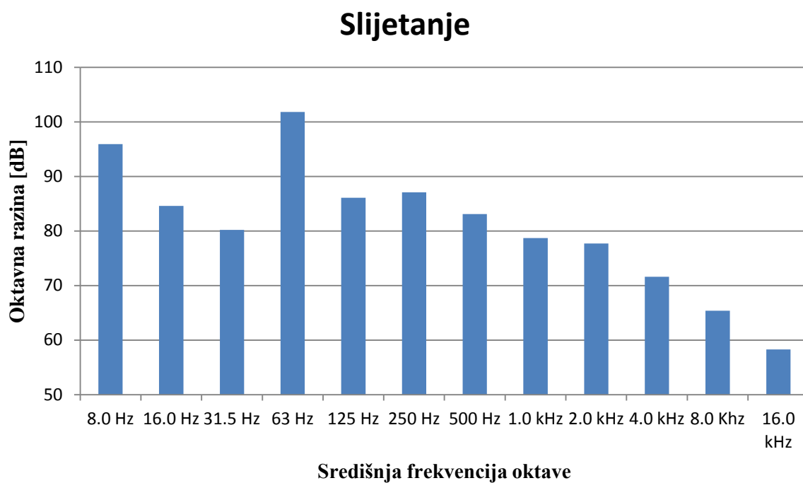
Slika 24. Grafikon unutarnjeg oktavnog mjernja buke zrakoplova CL-415 na slijetanju
