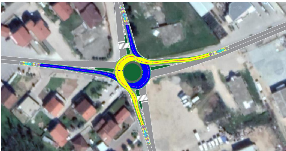
Slika 30. Trajektorija provoženja mjerodavnog vozila na raskrižju 2
