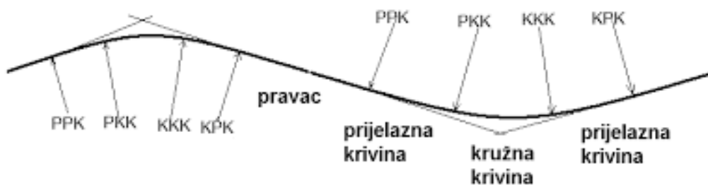
Slika 14. Tlocrtni elementi ceste [2]
