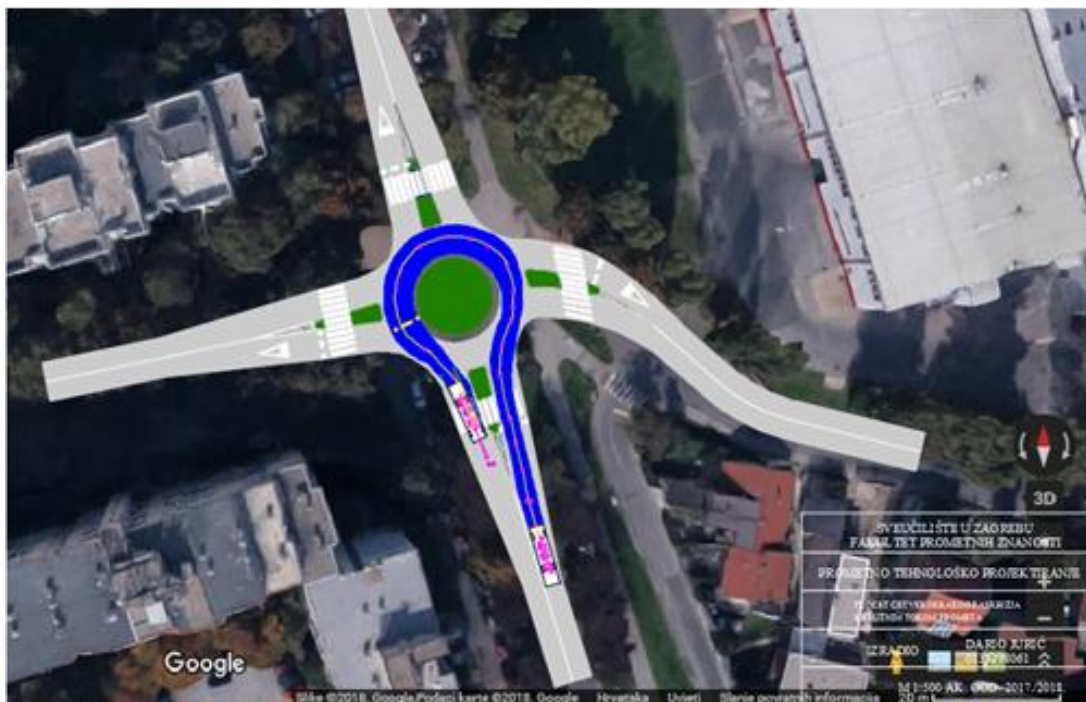
Slika 5.10. Provjera trajektorija raskrižje 3
