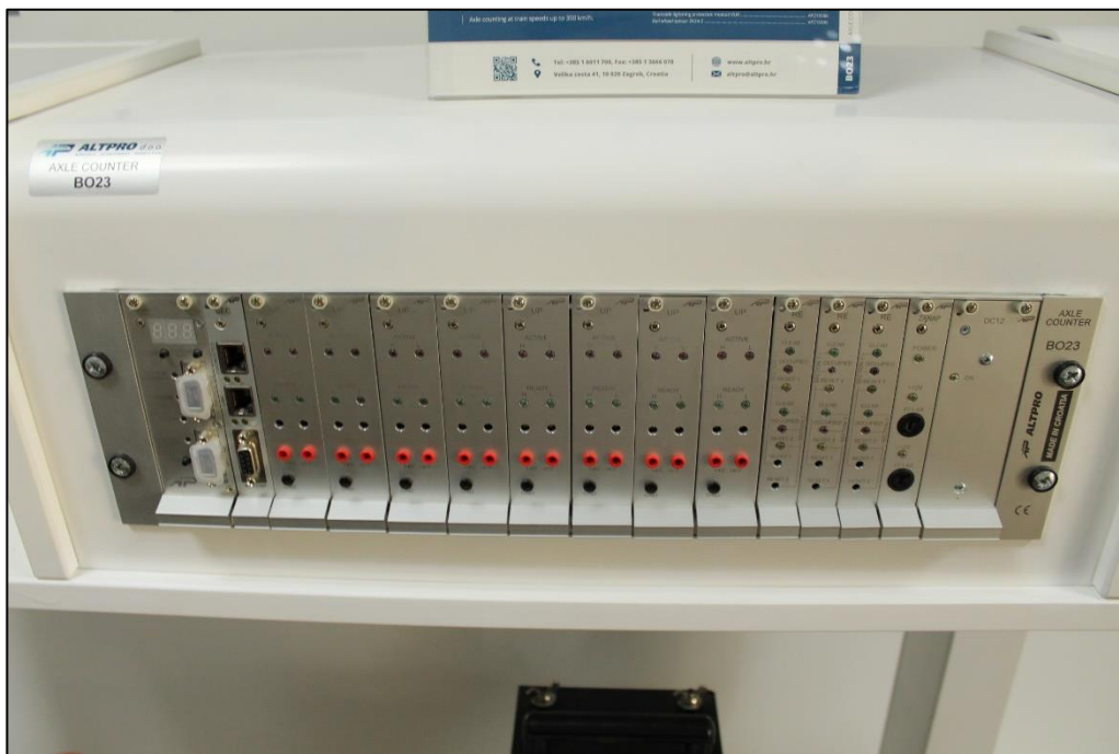
Slika 28. Brojač osovina BO-23 tvrtke Altpro d.o.o.
