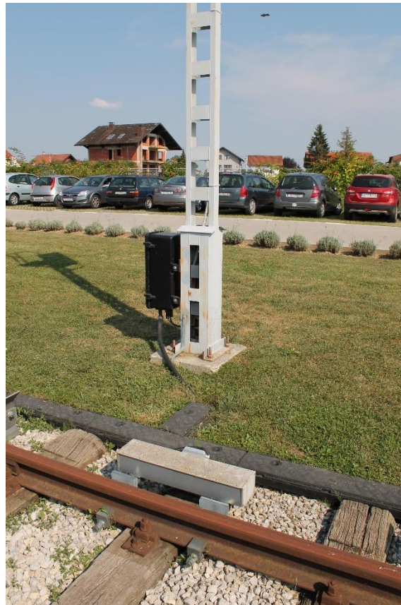
Slika 32. Pružna baliza autostop uređaja RAS 8385 na poligonu tvrtke Altpro d.o.o.
