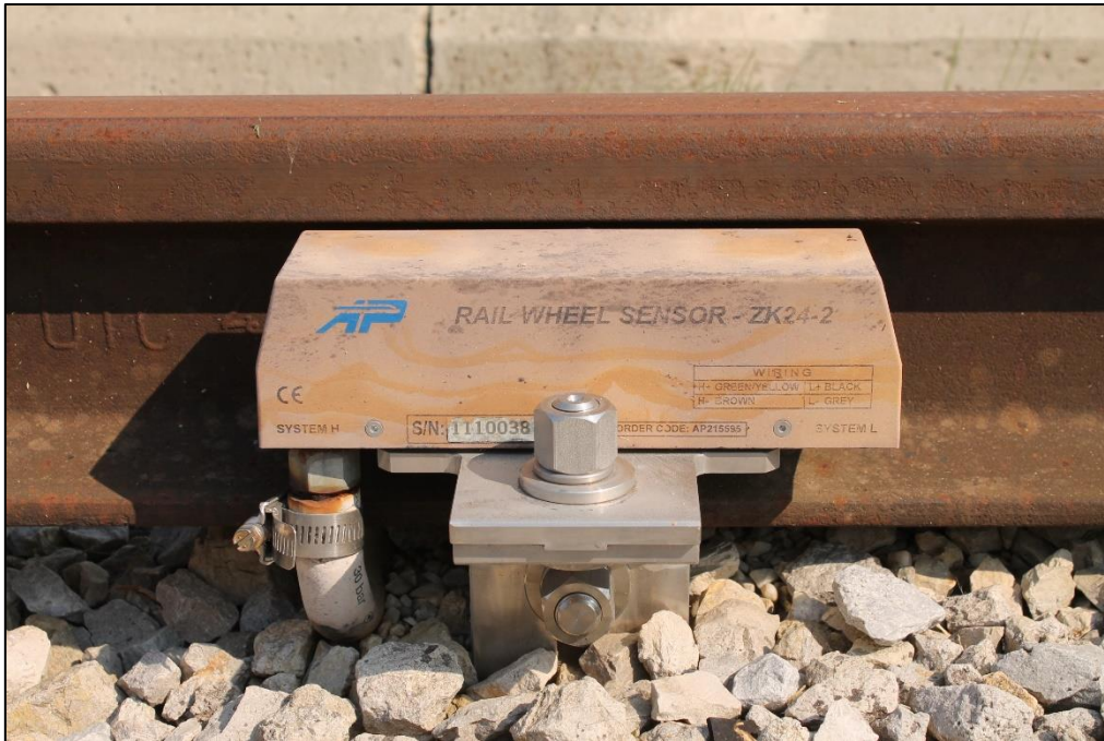
Slika 25. Senzor željezničkog kotača ZK24-2
