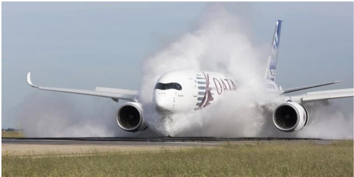
Slika 9. – Stajaća voda na uzletno - sletnoj stazi 9
