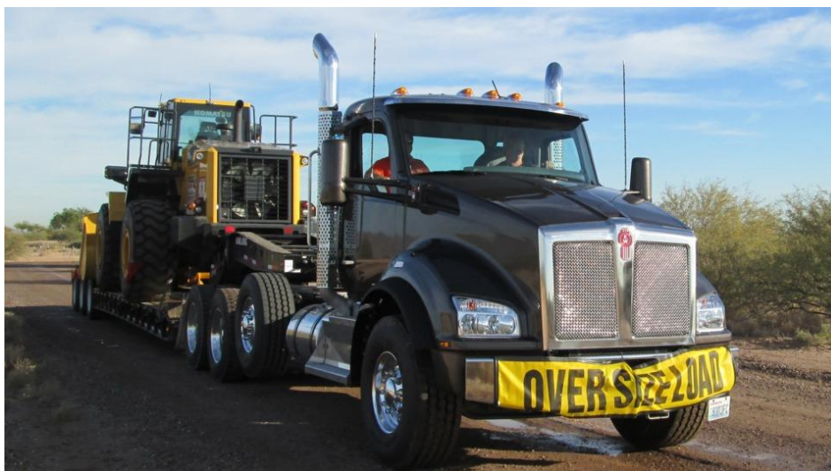
Slika 5 Primjer tegljača i poluprikolice za obavljanje prijevoza specijalnih tereta
