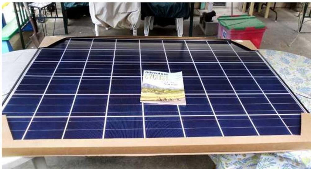
Slika 9. Primjer zaštite solarnih panela prilikom prijevoza
