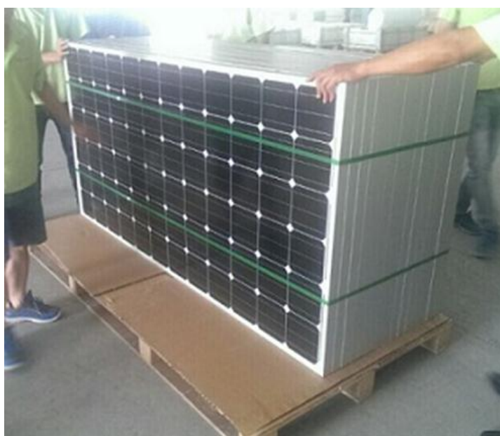
Slika 10. Način slaganja solarnih panela na paletu
