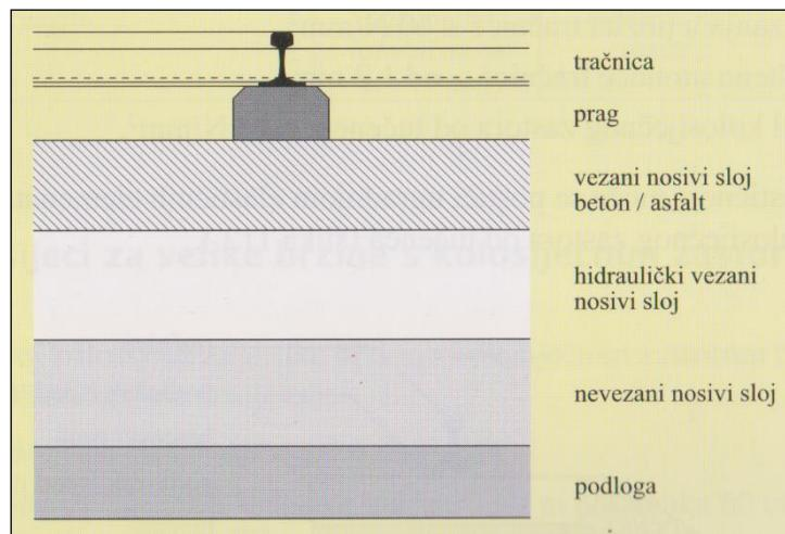
Slika 2.3. Konstrukcija kolosijeka na čvrstoj podlozi [2]
