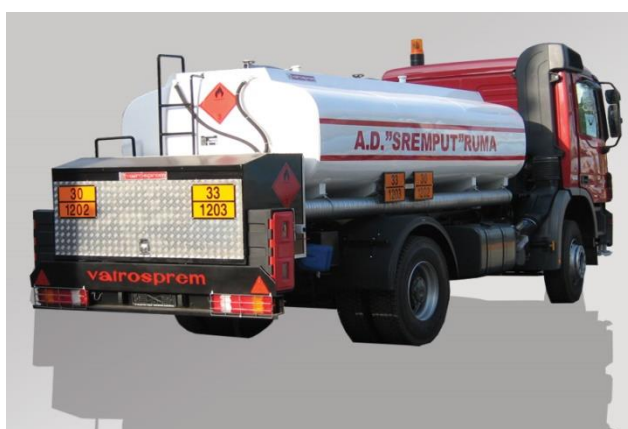
Slika 1: Oznaka za prijevoz opasnog tereta (zapaljiva tekućina), način postavljanja oznake na prijevozno sredstvo
