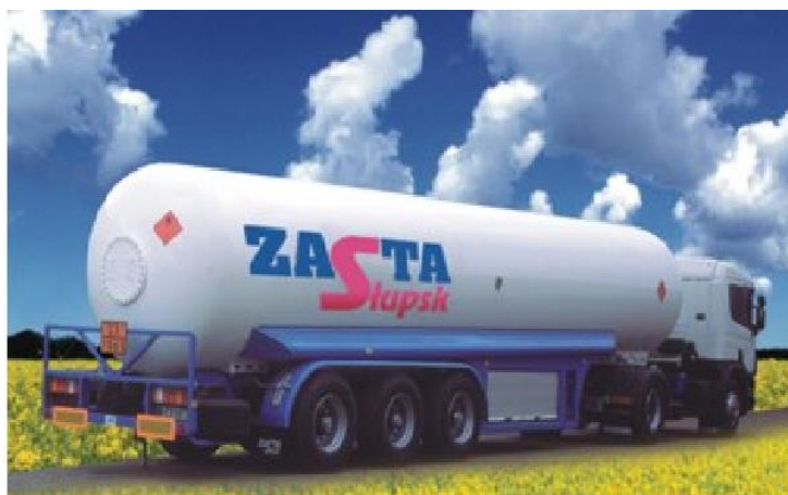
Slika 3: Polu-prikolica za prijevoz LPG-a tipa Zasta N-40; Zasta N-42
