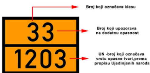
Slika 1: Oznaka za prijevoz opasnog tereta (zapaljiva tekućina), način postavljanja oznake na prijevozno sredstvo
