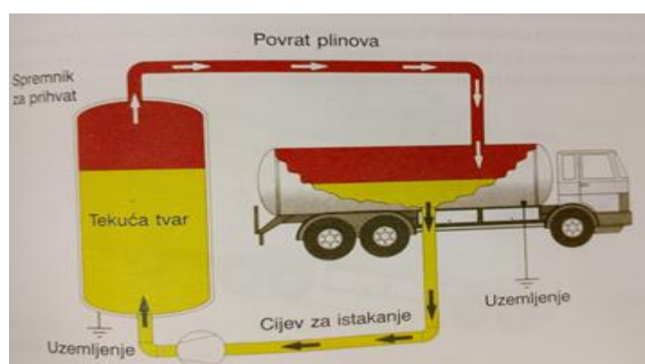
Slika 11: Pražnjenje cisterne zatvorenim EKO sustavom
