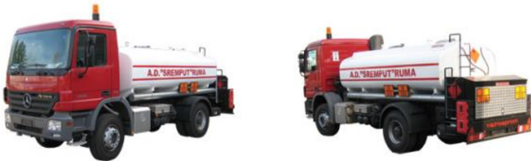
Slika 7: Cisterna tipa VCG-9 za prijevoz goriva
