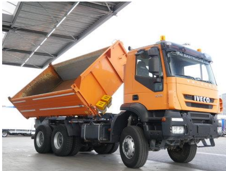
Slika 1. Kamion kiper za prijevoz kamenog materijala
