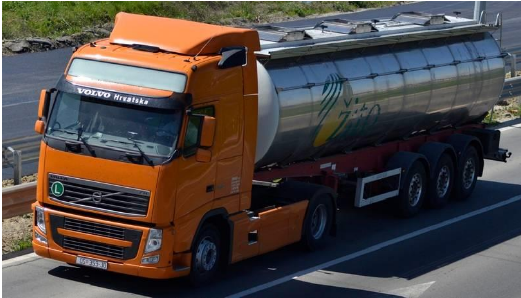
Slika 4. Tegljač i cisterna za prijevoz žita
