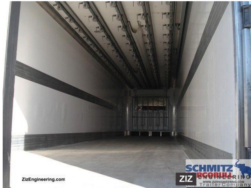
Slika 5 Prikaz poluprikolice sa kukama
