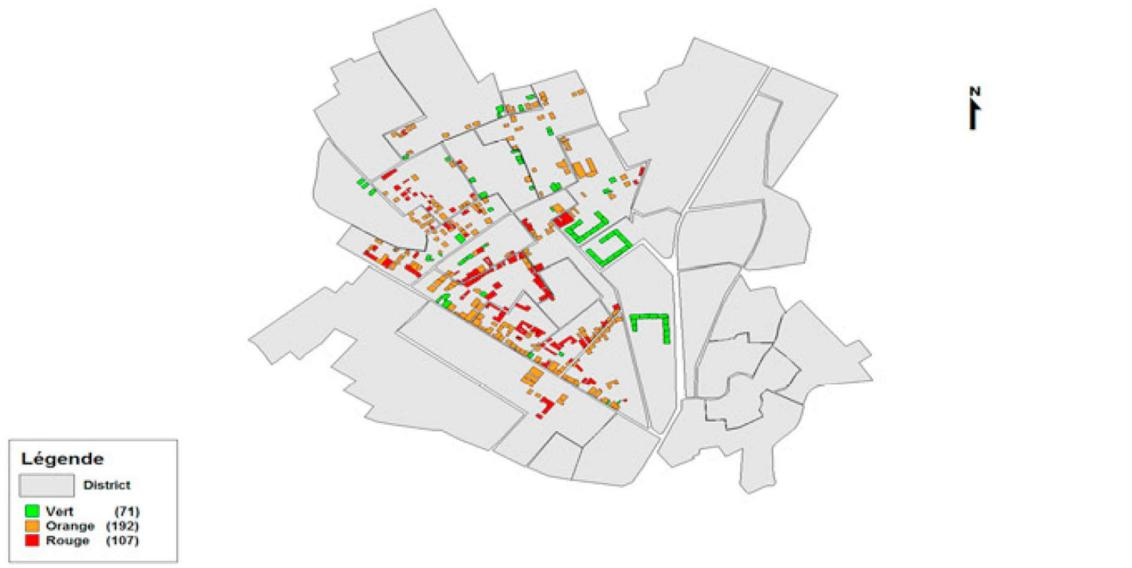
Slika 2-3. Klasifikacija građevina prema otpornosti na potrese pomoću GIS-a
