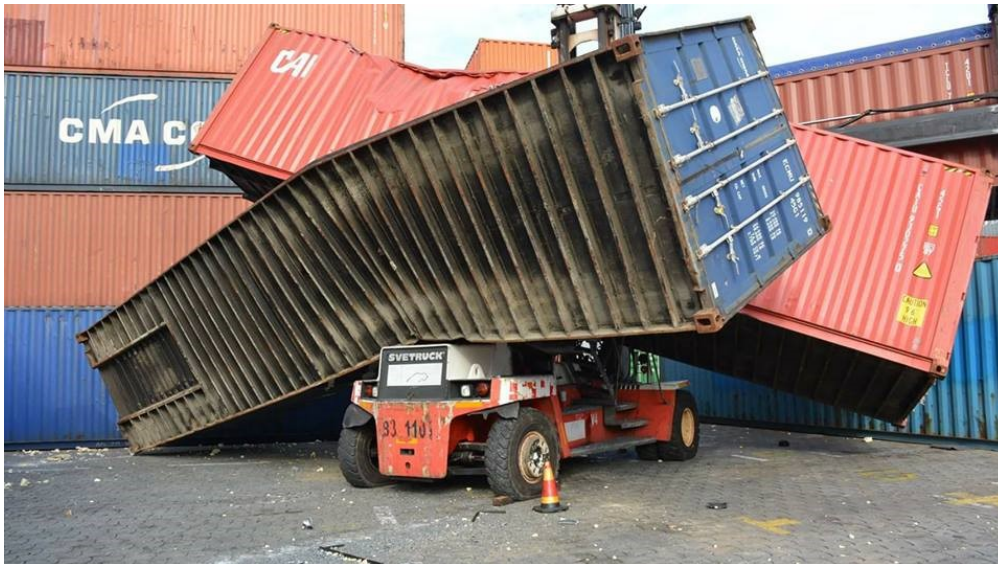
Slika 10: Fizičko oštećenje prilikom nepravilnog korištenja prekrcajne mehanizacije 36
