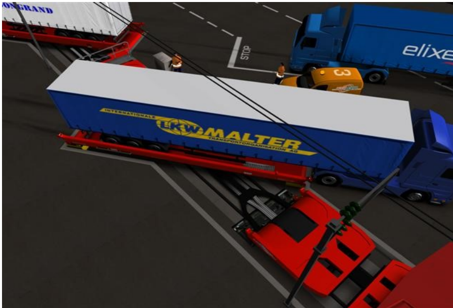
Slika 7: Prikaz Modalohr tehnologije 27
