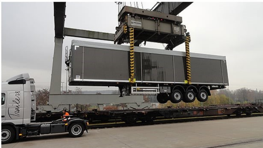
Slika 6: Prikaz Huckepack tehnologije C 24
