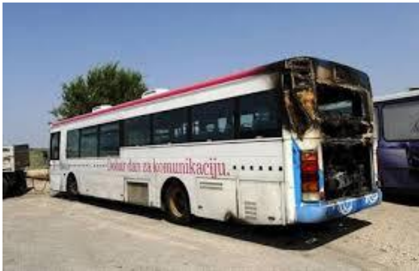
Slika 6. Samozapaljenje autobusa uzrokovano lošim održavanjem
