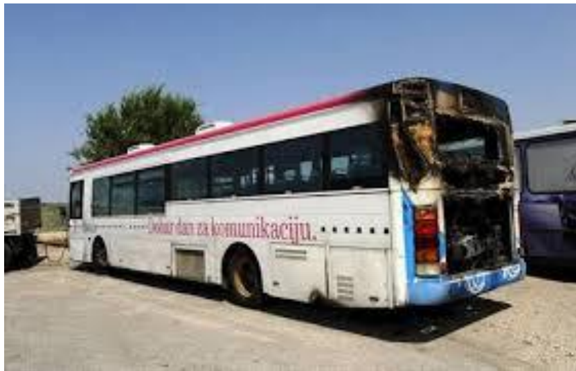
Slika 6. Samozapaljenje autobusa uzrokovano lošim održavanjem
