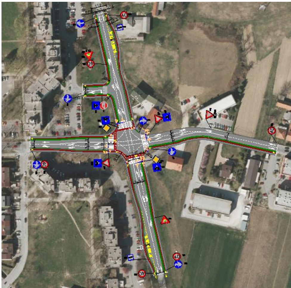
Slika 21. Varijanta 3-četverokrako raskrižje upravljano prometnim svjetlima
