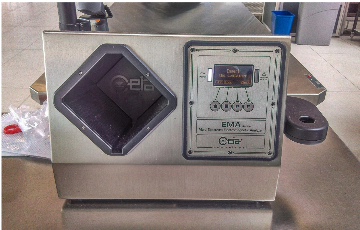
Slika 14. Elektromagnetski uređaj za analizu tekućina - EMA
