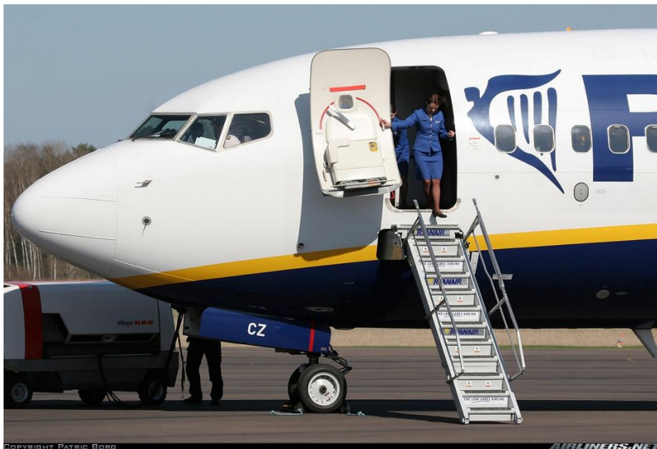
Slika 4: Vlastite stepenice kod B737-8
