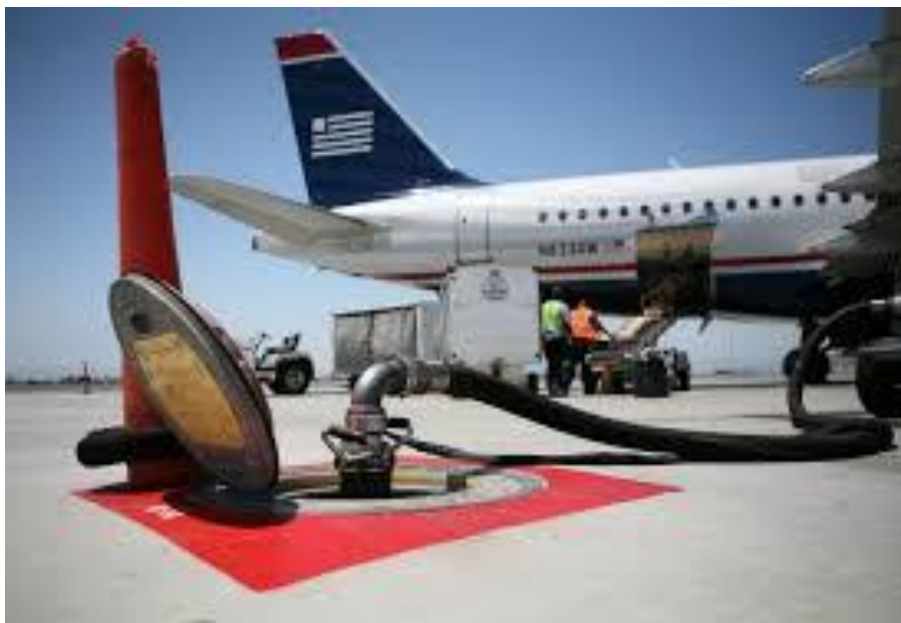
Slika 6: Samohodna pumpa za gorivo koja je spojena na podzemnu cisternu Izvor: [19]
