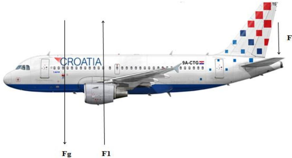
**Slika 13.** Težište zrakoplova pomaknuto prema unazad
