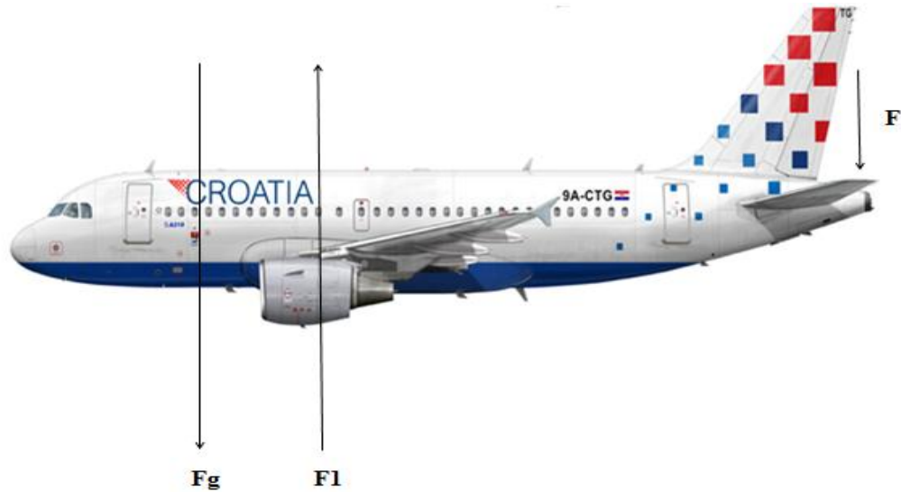
Slika 13. Težište zrakoplova pomaknuto prema unazad Izvor: [12]
