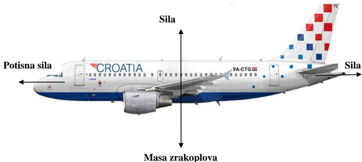
**Slika 2.** Aerodinamične sile koje djeluju na zrakoplov u letu
