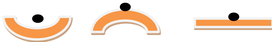
Slika 1. Stabilnost, labilnost i indiferentnost Izvor: [1]
