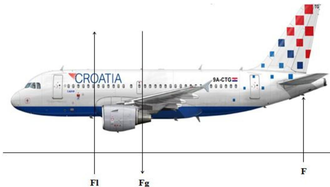
**Slika 12.** Težište zrakoplova pomaknuto prema naprijed
