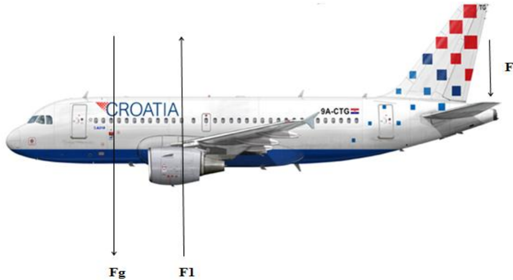
Slika 13. Težište zrakoplova pomaknuto prema unazad Izvor: [12]
