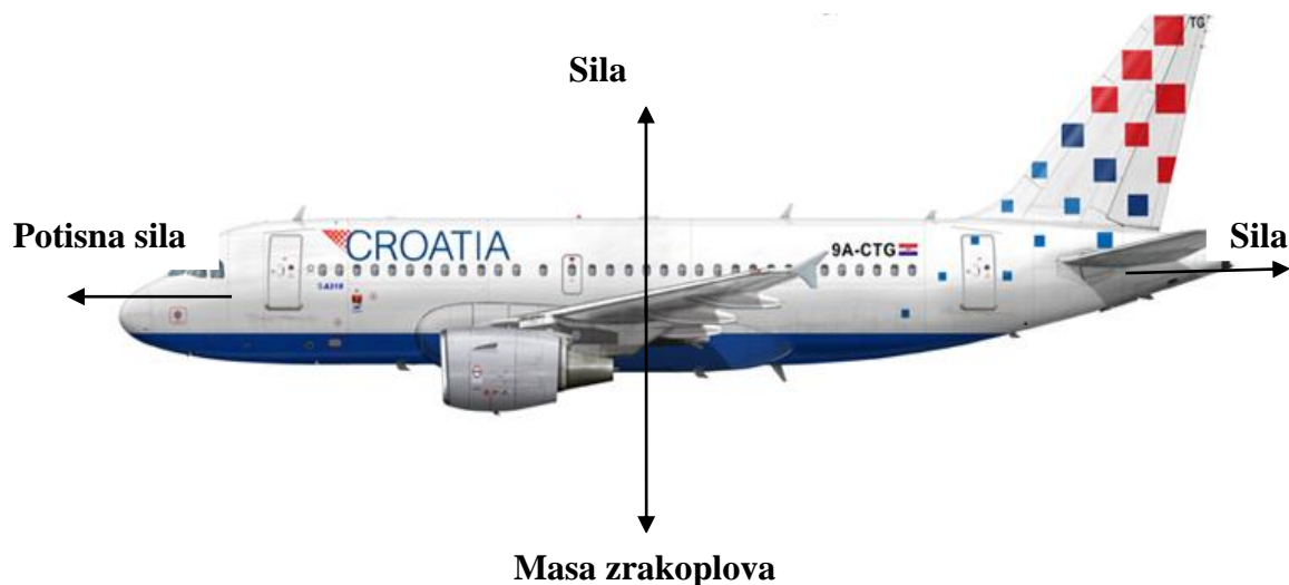
Slika 2. Aerodinamične sile koje djeluju na zrakoplov u letu Izvor: [2]
