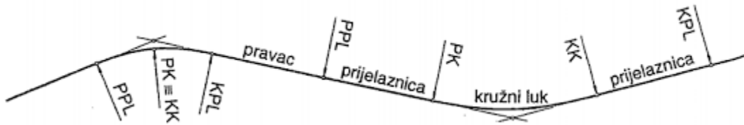
Slika 6. Trasa ceste u tlocrtu [6]
