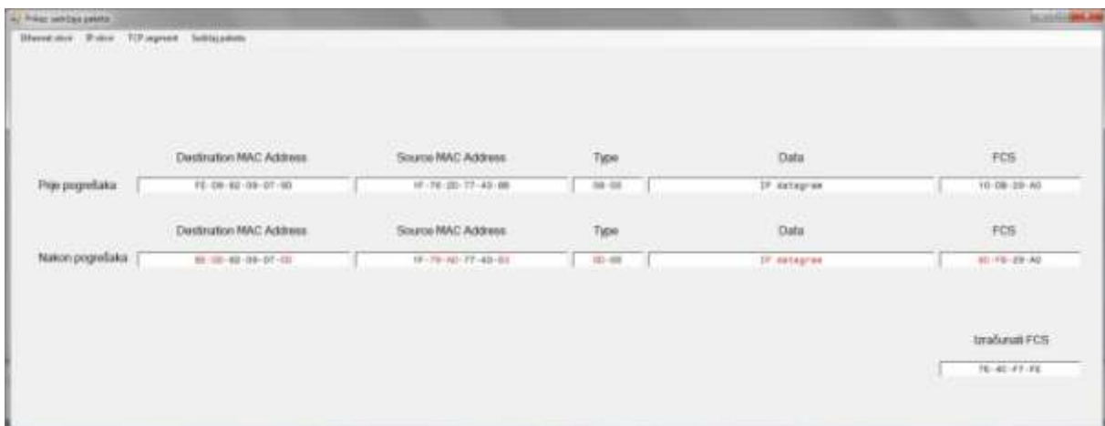
Slika 19. Prikaz Ethernet zaglavlja paketa
