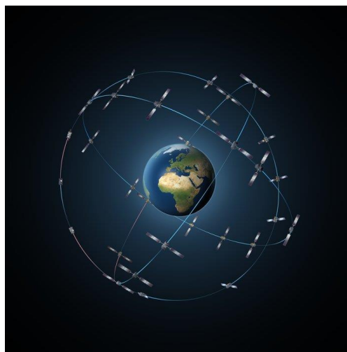
Slika 11. Prikaz konfiguracije satelita iz Galileo navigacijskog satelitskog sustava
