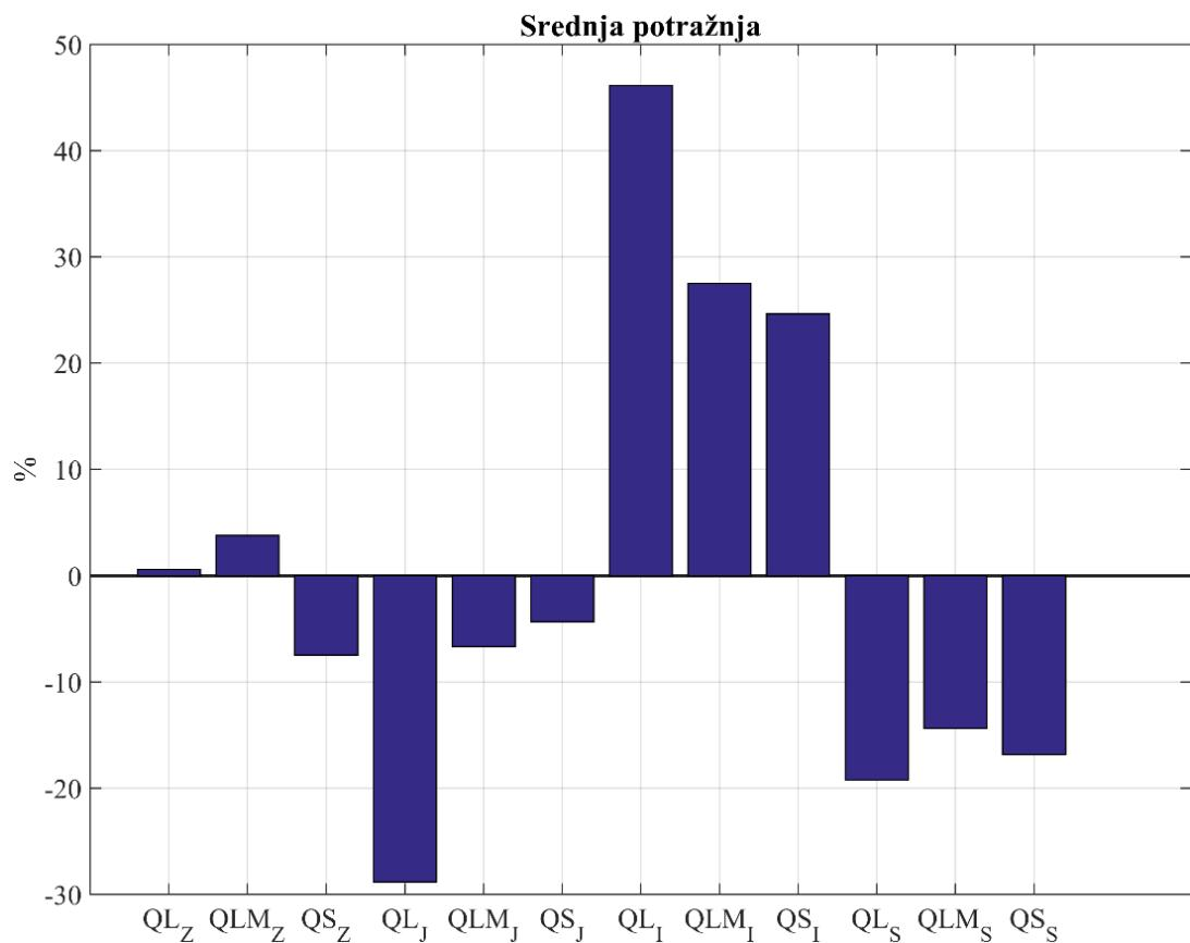
Slika 25. Rezultati usporedbe srednje potražnje adaptivnog i fiksнog upravljanja korištenjem alternativne strukture NEMA
