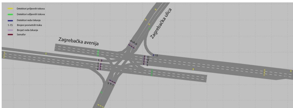
Slika 9. Prikaz označavanja detektora unutar modela semaforiziranog raskrižja
