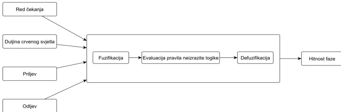
Slika 8. Prikaz cijelogupnog djelovanja neizrazitog sustava za izmjenu faza
