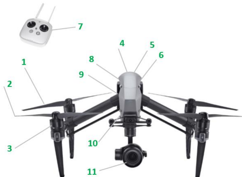
Slika 3. Glavne komponente dronova
