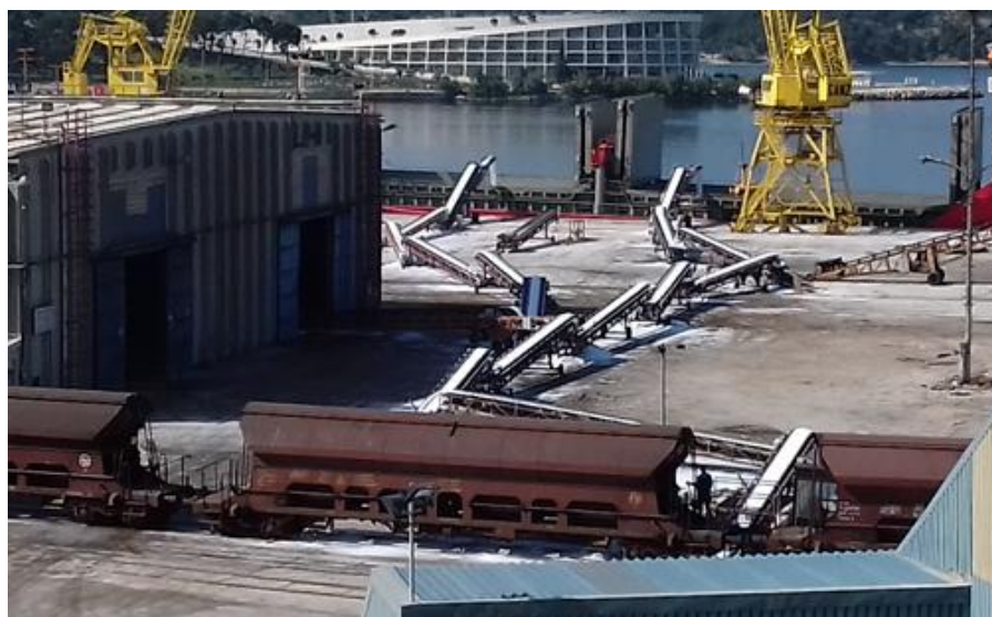
Slika 23. Istovar vagona preko kolosijeka Dobrika 1 Izvor: Autor
