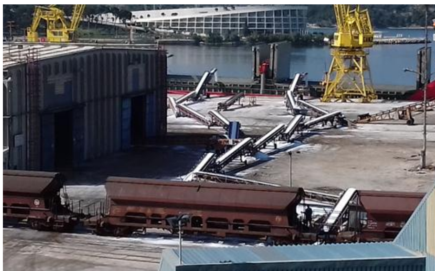
Slika 23. Istovar vagona preko kolosijeka Dobrika 1 Izvor: Autor
