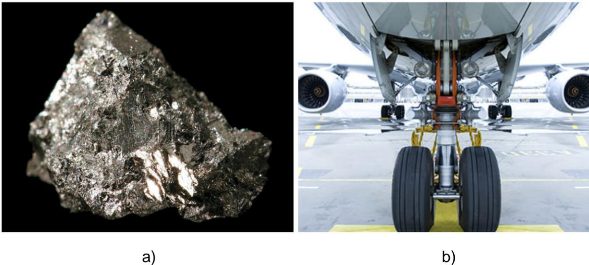
Slika 5: a) Berilij kao materijal; b) Berilij u uporabi kod izrade kočnica zrakoplova
