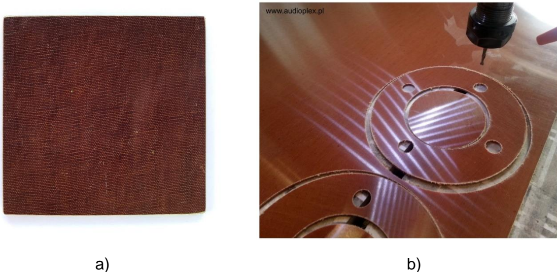
Slika 9: a) Tekstolit kao materijal; b) Prikaz izrade dijelova od tekstolita
