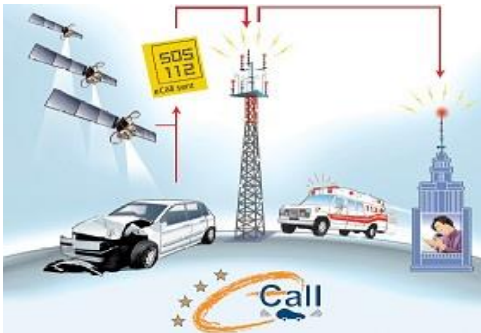
Slika 7. Princip rada eCall-a [13]
