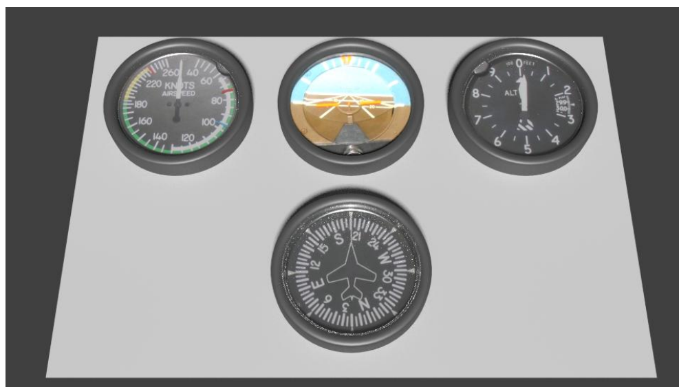
Slika 3.11. T-model rasporeda prikaznika;
