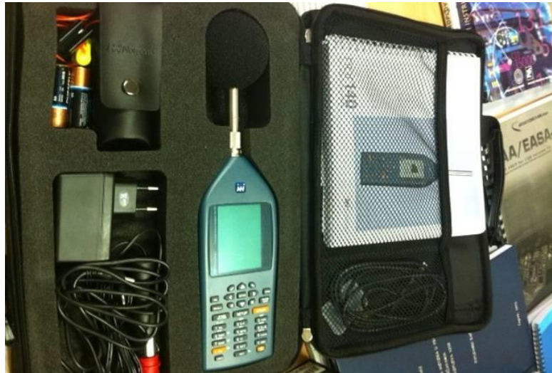
Slika 4.17. Zvukomjer Nor140 Izvor: Preuzeto od Ivošević, J. 2013. [17]
