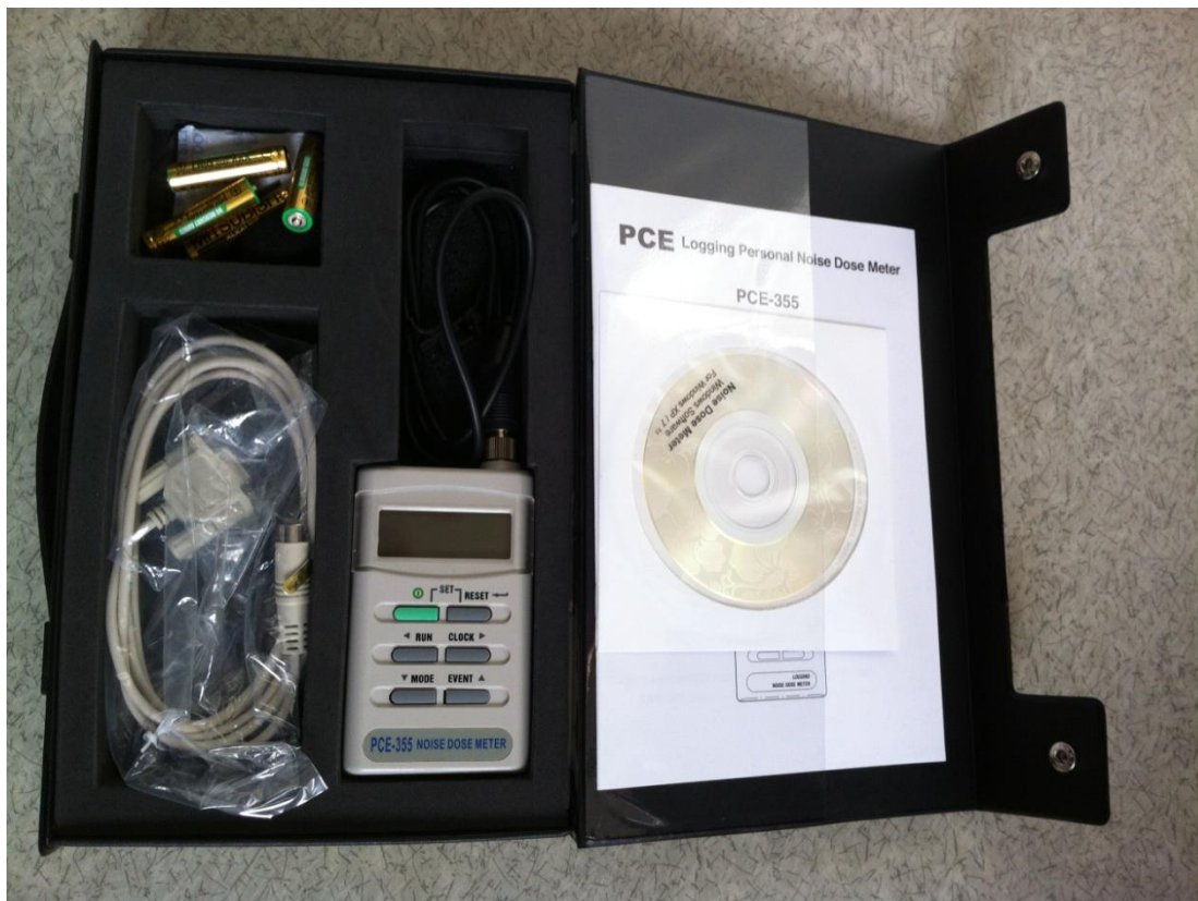
Slika 4.16. Dozimetar buke PCE – 355 Izvor: Preuzeto od Ivošević, J. 2013. [17]
